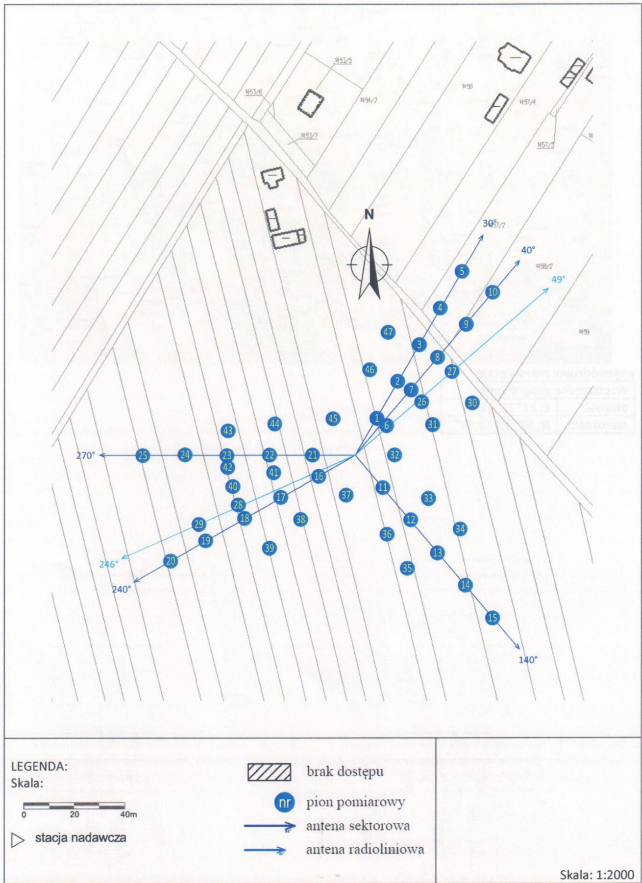
Załącznik 2. Widok pionów pomiarowych
